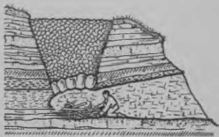
12-шы карт. Извоска йылатымы проста камакам кытын покшәц пйчмйлә анчыктымы. Извоскагүм кырык тй эш йштймй йәмйшкй опат. Лйвәләнжй тылым опат.
