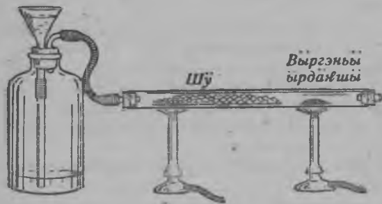
83-шы карт. Вĕргĕнĕ окисĕм угльеродын окисĕтон востанавльвайымаш.
