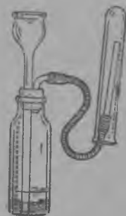
26-шы карт. Пробиркйм водородтон тәмймәш. Кымыктымы пробиркйштышй въздухым водород шйкән лыктәш.
