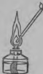
64-шы карт. Спирт лампын тыл салымжы- гѣц спирт па- рым әрдѣшкѣ лыкмәш.
