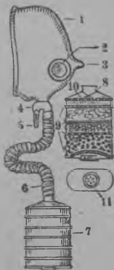
19 тяш. Противогазсь. 1 — маскась. 2 — глянцягне (сельме ваноматне). 3 — шалкконясь, сурса потму шарфтозь мархтонза — нарнесазь глянцянтвень. 4 — тройниксь. 5 — потмоса ваймень таргсема клапансь. 6 — трубкась. 7 — противогазсь. 8 — противогазсь пачк керфста. 9 и 10 — ниленди веществань слоень аерфни решеткатне. 11 — потму ваймень таргсемань клапансь.
