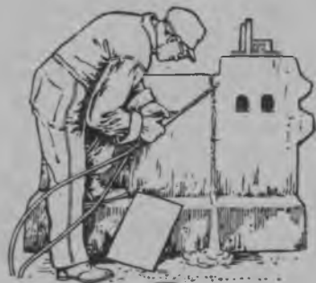
16 рис. Металлонь керсема ацетиленэнь-кислородонь толсо.
