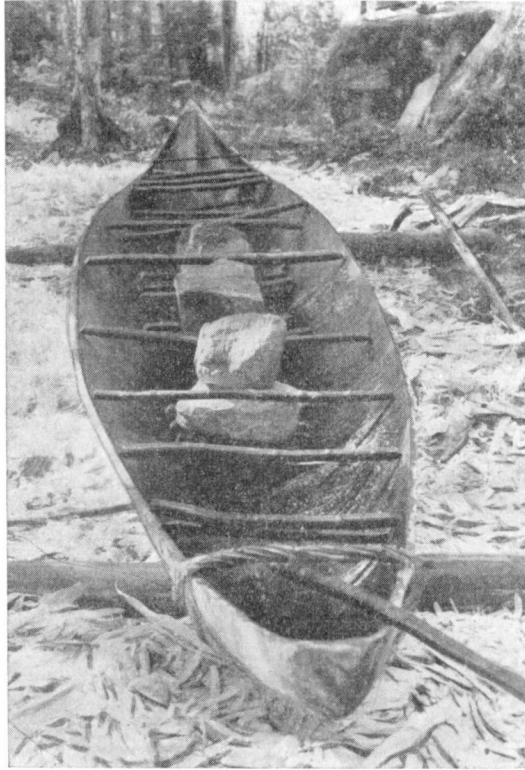
Kuva 29. Pohjanmuotoa korjataan kivillä, joita asetellaan »nyttien» päälle. Ahlainen. Valok. E. Nikkilä.
