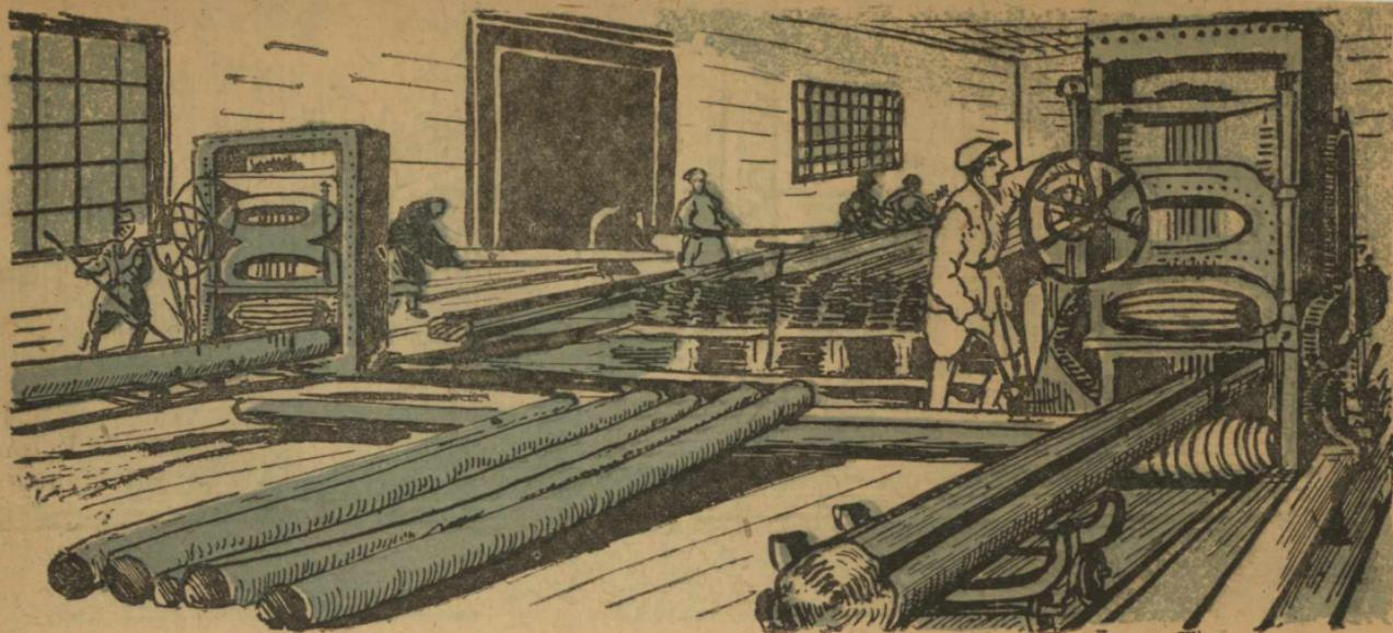
Гожомын вәрпілітан заводас көрсөттесе көшкіда васыс-і катоффоны. Көрталасны көрсөттебін, а чепсө кысыны лөгөдөма аслыс пәлдес машина. Кор көржес завод пыщкас вояс, сійоң пүктөні төлеңека вылға да жіткінші пілітан станок. Пілітан рамалдан дас піла, он-і тәдлі, шарқашасны көрт. Петбони жежығік, мічаңкі төсөјас. Гөрбушасың гөгрөс пілабын пілітоны реїкалас.
