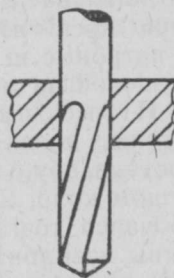
140 сер. Ташöм пыдö пiскöдчантö суҗöмгыс абу бур: пiскöдчаныс вермас чегны.
