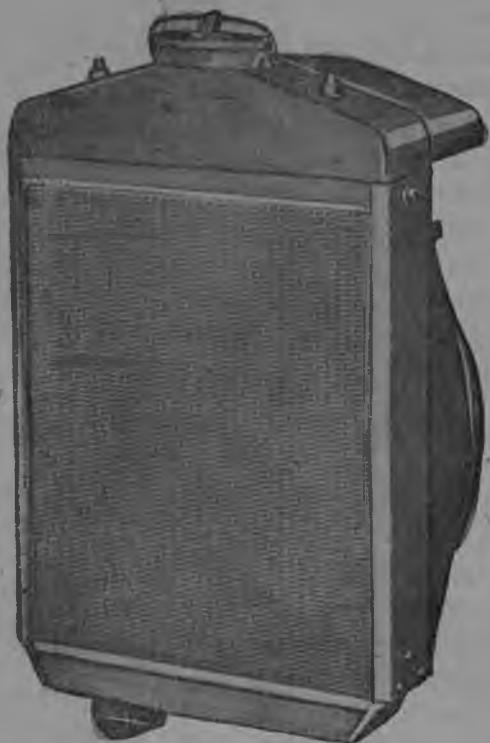
Трактырым анцыл вэлц анчымэт кодым сэк пытэрлиок тэвэ мам ужат. Тиды—радиатор манмы ылэш. Тиды малан кэрэл? Мотор ровотайым годым ма лиалтэш. Соок кырэсингээ пыдэштэш. Ти пыдэштэлтмэйвлэш мотор ырэн шынцэш. Моторлан тиды пиш худа: шокшэш моторын часть-авлэшты кымдаэмийт шырыш ийлаш түнгэлэш. Шырыштэ цилэ частьавлэх икйжэх икты тэрвэшьшты тьоралтыт, цаш тыйгэнэт. Сэдйиндон, моторым хоть мада үкшыктымэйлэ. Ти радыяитырыш вайдыим оптал
