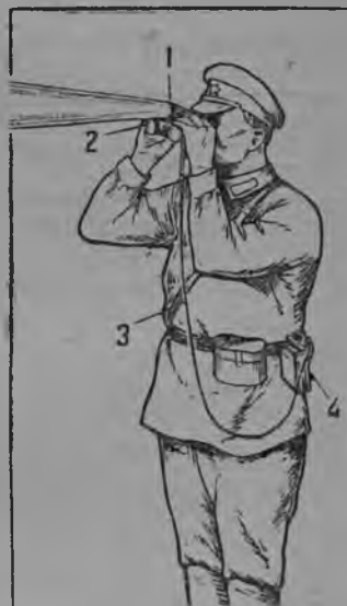
164 сўр. Увэр пуышо лампым бинокльыш пыжыктымэ. 1—увэр пуышо лампэ, 2—бинокль, 3—провод-влак, 4—лампэ батарэй.
