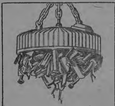
84 сўр. Нѳлтымѳ кранын ѳлектром- магнитшѳ.
