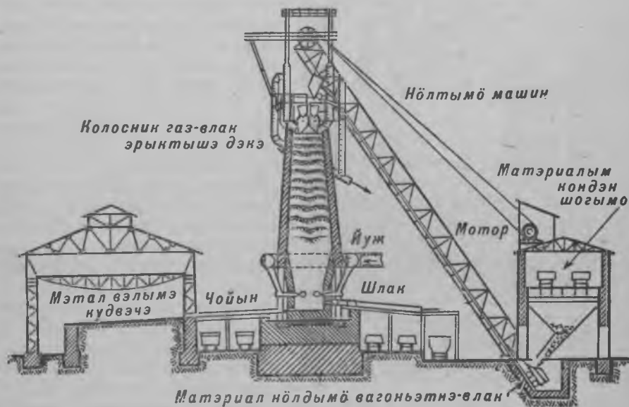
87 сур. Домна конган схэмжэ (покшэч пучмыла ончыкталтын).
