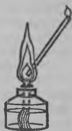
67 сўр. Спирт лампэ тул кўргысё спирт пар-влакым ёрдышкё пуч дэнэ лукмаш.
