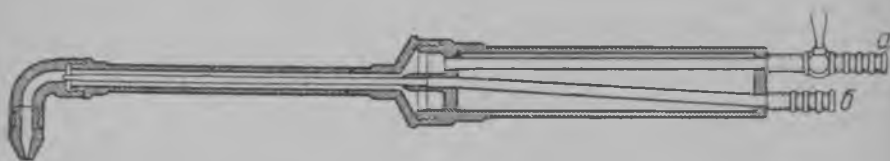
14 тяш. Ацетиленокислородной горелкась. a трубкаться эзга сувай ацетиленсь, b трубкаться эзга — кислородсь.
