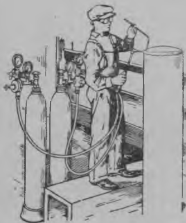
15 тяш. Ацетиленокислородной горелкаться вельде кшнить сваркац. Проволкась, конанц мастерсь кирьдъсы кядьсонза, шяняды и пяшкельдъсь предметть стафксонц (лазф вастонц).
